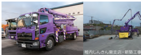
現場から戻ると急いでポンプ車を洗浄し、保守、管理を怠らない。ポンプ車には、経済性に優れたスクイーズ式（絞り出し式）と大規模な建設工事に圧送性能を発揮するピストン式（押し出し式）があり、いずれもデジタルラジコンと操作パネルを用い、生コンを圧送する。
