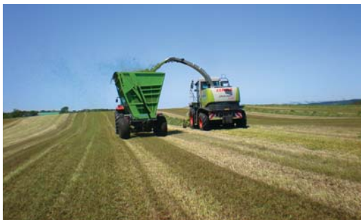
自走ハーベスターによる牧草収穫作業 サイレージづくりは、草刈り、収穫、積み込み、鎮圧、そしてラッピングまで全工程を大型の特殊機械（重機）で行っている。
